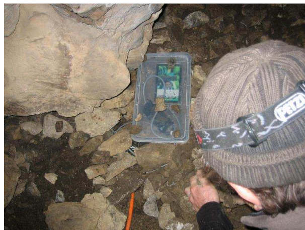
Boîtier comptabilisant le nombre de passages (SIC n°7) (© M. NEMOZ)
